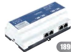
Convertisseur Ethernet/DMX sur rail DIN pour installations fixes - 4 ports DMX - 2 ports Ethernet - Compatible DMX 512-A, RDM, ArtNet, sACN, RTTrPL (BlackTraX) - Possibilité d'alimentation via Ethernet (PoE). Existe en version Euroblock (LU-0100042-TB)
