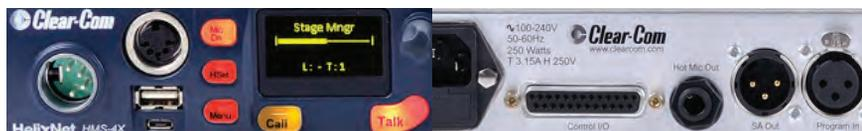
**A**vec la gamme HelixNet, Clear-Com propose une alternative numérique aux systèmes intercom 2 fils partyline conventionnels. Avec un protocole propriétaire, il est désormais possible de transporter jusqu'à 24 canaux audio, ainsi que l'alimentation des boîtiers, sur un simple câble micro standard XLR, en permettant de connecter les boîtiers aussi bien en les reliant directement les uns aux autres, qu'en
