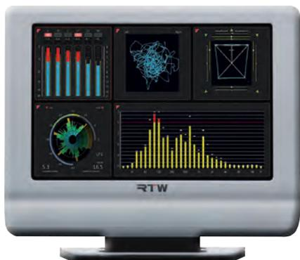
Le TouchMonitor, disponible avec écran 7" ou 9" (TM7 ou TM9) possède 8 entrées AES et analogiques et peut afficher jusqu'à 16 bargraphs simultanément. Avec l'option 3G-SDI, c'est un total de 32 signaux qui pourront être mesurés.
