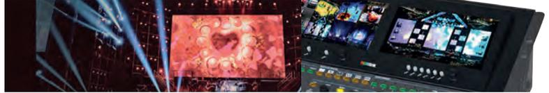
**M**3 rassemble dans une console de pilotage modulaire toutes les fonctionnalités de commutation et de mixage. Le mélangeur vidéo dispose d'un mode broadcast pour un accès rapide pendant le direct, tandis que les afficheurs LCD intégrés permettent le monitoring vidéo de toutes les sources, des sorties et du
