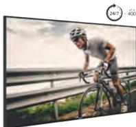
Les dalles d'écrans utilisées pour cette série sont conçus afin de fonctionner de manière illimitée, 7j/7 et 24 h/j, sans aucun problème. Nos gammes d'écrans professionnels proposent des niveaux de luminosité adaptés (jusqu'à 2500 Cd/m<sup>2</sup>) à un environnement intérieur très lumineux.
