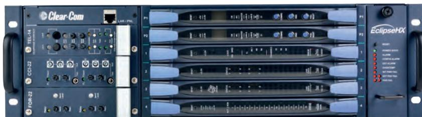
Matrice intercom numérique modulaire avec 4 slots pour cartes d'extension gamme Eclipse HX et 3 pour modules d'interfaçage. Jusqu'à 256 ports internes. 2 alimentations externes redondées incluses. 2 slots pour cartes CPU redondées incluses. 8 GPIO sur 2 x DB25.
