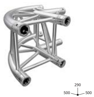
90° ECKE | CORNER C21 mit abgerundeten Ecken CODE F34C21-R500
