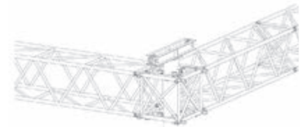
Junior Tower mit LSC-FR Sleeve Block und LSC-FR-JT Rahmen Höhe 8 m
